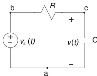
**FIGURE 4.7:** A simple RC circuit.
