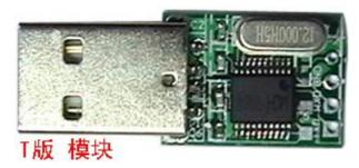
下面是 T 版模块的应用接线图。应用时需要焊接 3 根线,实现三线制 TTL 串口。注意在与单片机 串口连接时,模块的 RXD 接单片机的 TXD,模块的 TXD 接单片机的 RXD。
