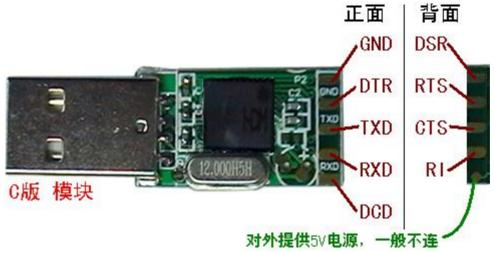
注意,实际的 C 版模块有三种电路结构,三者功能相同,接线方式相同,但是外观有些差别。第一种是采用 SSOP20 封装的 CH340T,PCB 尺寸为 25mm\*16.5mm; 第二种是采用 SOP28 封装的 CH341A 芯片,PCB 尺寸为 31mm\*17mm; 第三种如上图所述,成本相对较低,PCB 尺寸为 26mm\*15mm,但仅适用于批量加工。
