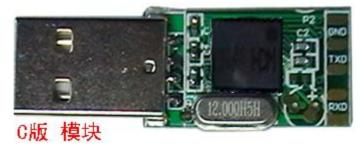
下面是 C 版模块的应用接线图。模块右端的正面及背面各有 5 个焊点,其中背面一个较小的焊点是 5V 电源,一般情况下不连接。应用时需要焊接 3 根线或者 9 根线(含 MODEM 信号),所有信号都与计算机普通串口类似,区别仅在于电平不同,模块是 TTL 电平,而计算机普通串口是 RS232 电平。
