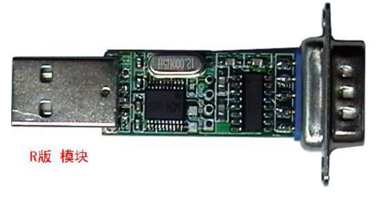
R 版模块的右端是 DB9 插座, 其引脚定义及外观形式都与计算机的普通串口类似, 但未提供 MODEM 信号, 只有最常用的 GND、TXD 和 RXD 信号, 实现三线制 RS232 串口。
